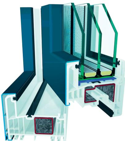
**Bild 3.** Die Geometrie aktueller Fensterprofile resultiert aus den Anforderungen an Dämmung, Stabilität und Funktionalität. Zum Dämmen wird ein System aus drei bis acht Luftkammern genutzt, für die Stabilität wird das Profil durch bis zu 0,7 mm dünne Stege im Inneren gestützt. © Gealan
